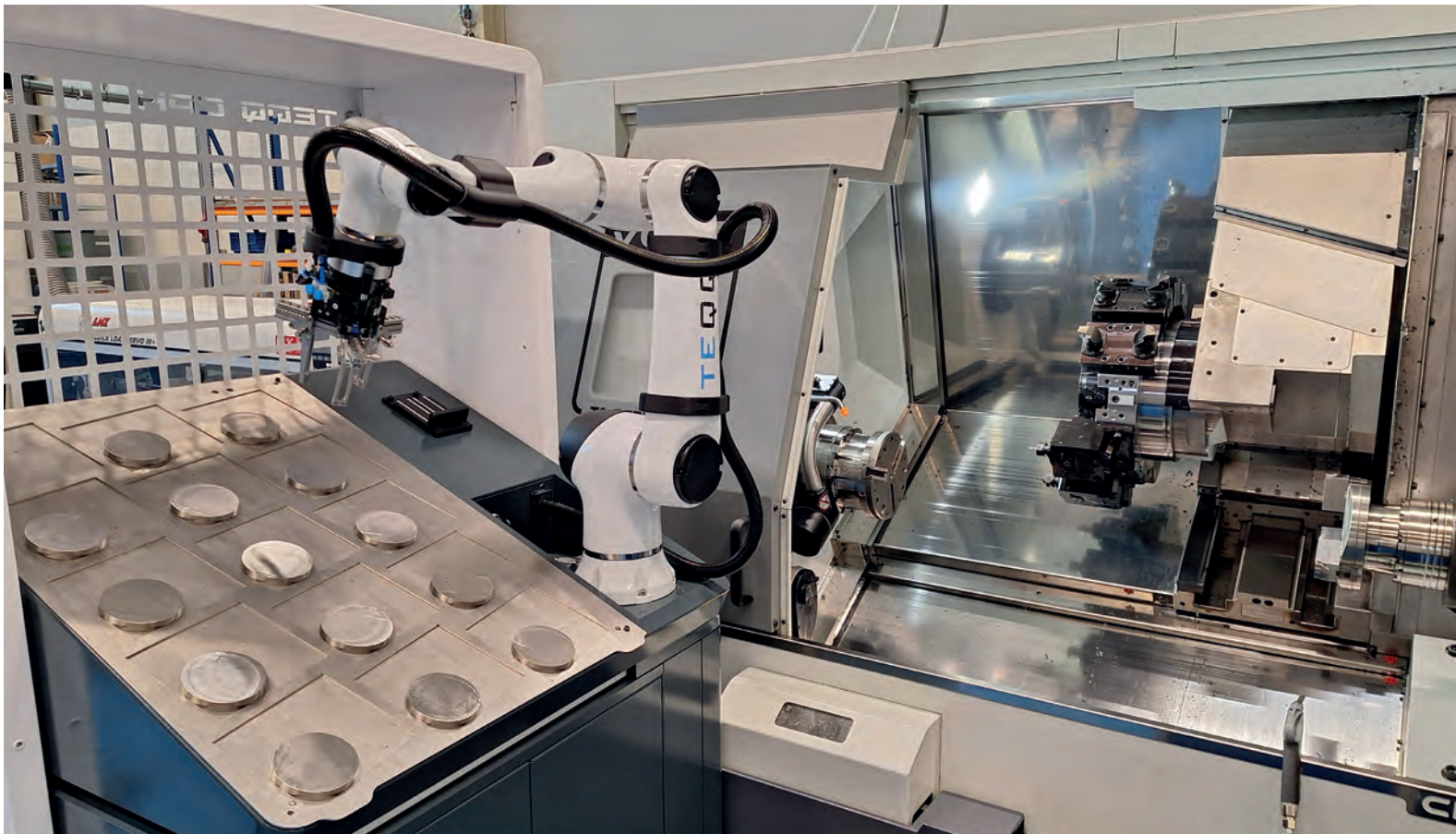
De Teqq is gebruikersvriendelijk, zonder dat programmeerkennis nodig is. Ook benut het systeem de draai- en freescentra beter.
