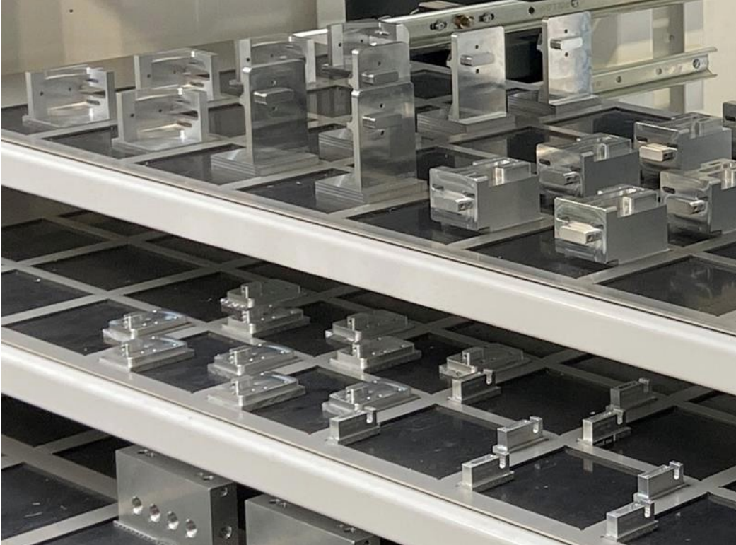
Componenten voor de draad- en kabelverwerkende industrie beladen op de robotcel die een combinatie vormt met de ACURA 65
