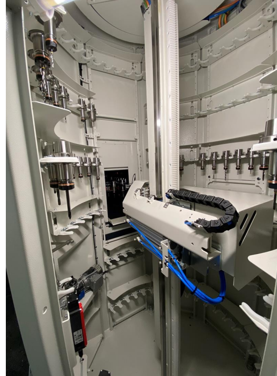
De ACURA 65 heeft een magazijn met een capaciteit van 245 gereedschappen
