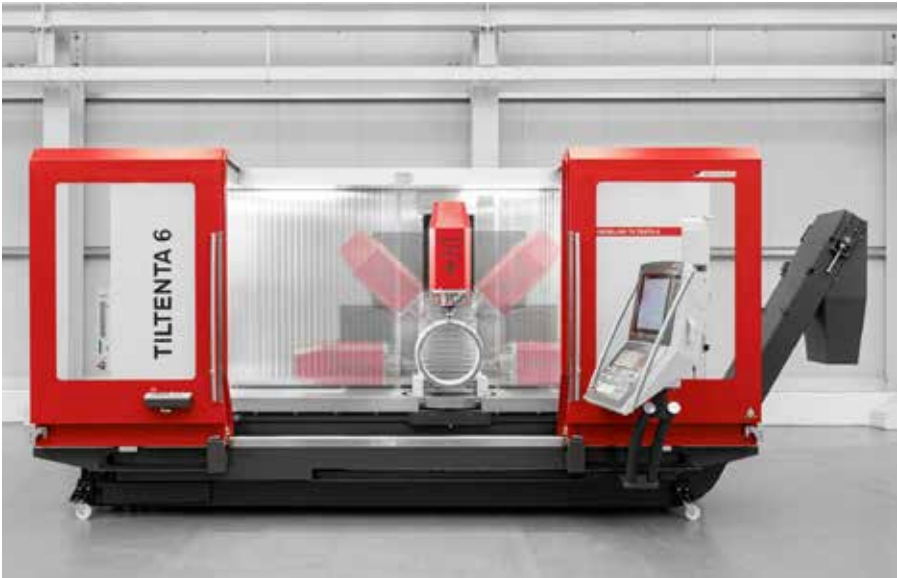
Dit systeem omvat een zwenkbare freeskop met snelheden tot 14.000 toeren/ minuut.
