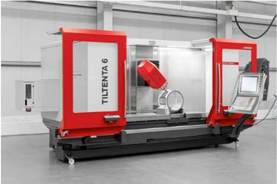
Deze TILTENTA is uitgerust met een beweegbare kolom en een vaste tafel met geïntegreerde NC tafel.
