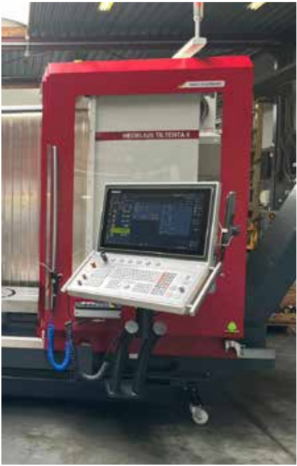
De bediening gebeurt via de meest recente Heidenhain-sturing, met name een intuïtieve TNC7-versie.
