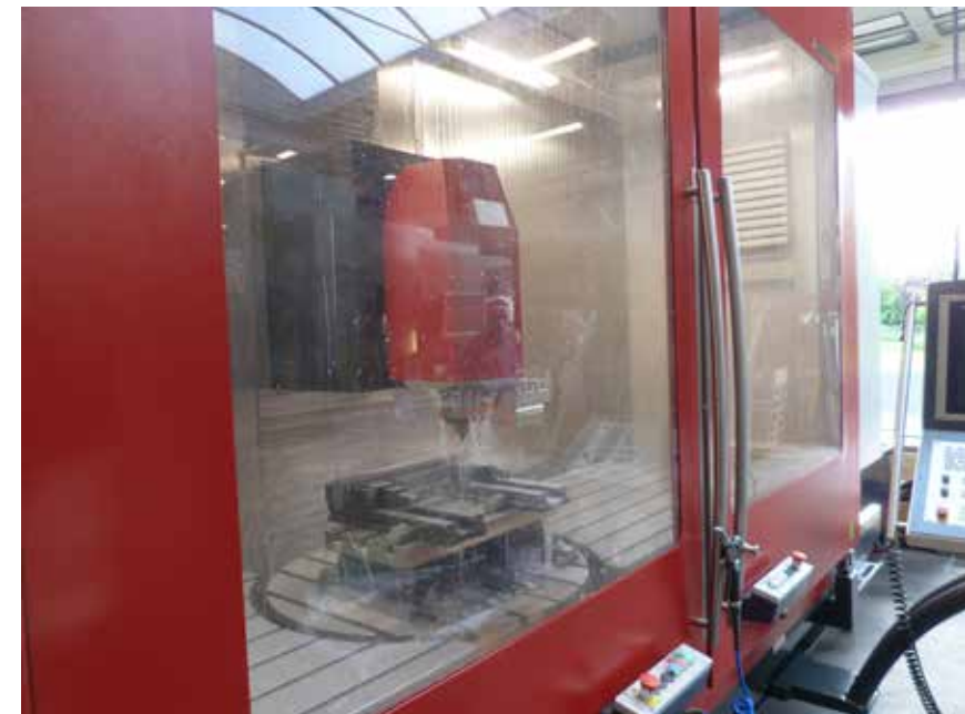
Dit systeem omvat een zwenkbare freeskop met snelheden tot 14.000 toeren per minuut. De bereikbaarheid van de tafel is optimaal dankzij de ergonomie van deze Hedelius.
