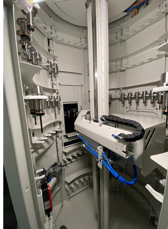
L'ACURA 65 dispose d'un magasin d'une capacité de 245 outils
