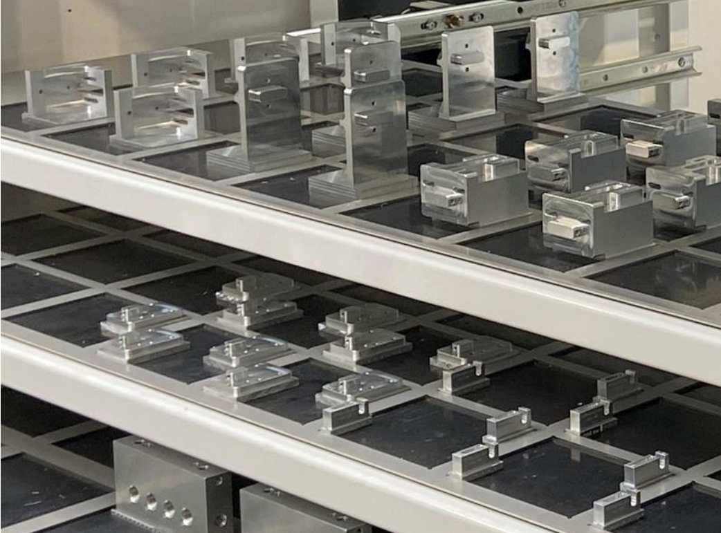
Des composants pour l'industrie du traitement des fils et des câbles chargés sur la cellule robotisée combinée à l'ACURA 65
