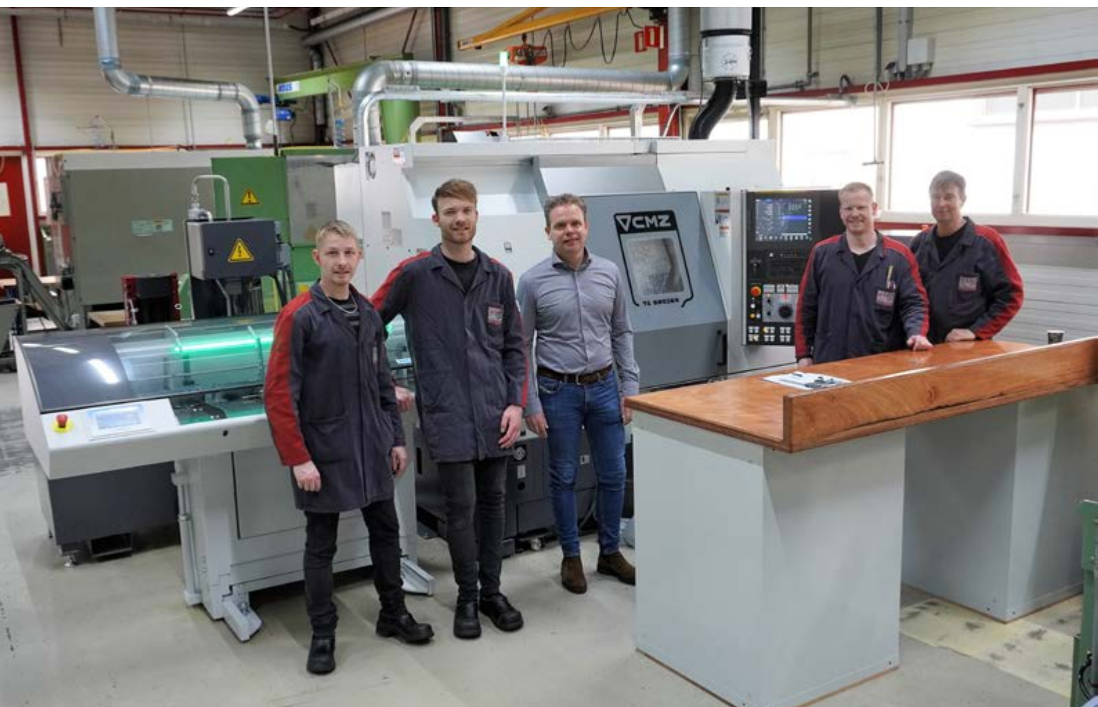
Het team van G.S.M. bij de nieuwe CMZ TA-20-YS-640 CNC-schuinbed draaibank. De toeleverancier zet de machine in voor het harddraaien van hoognauwkeurige onderdelen.
