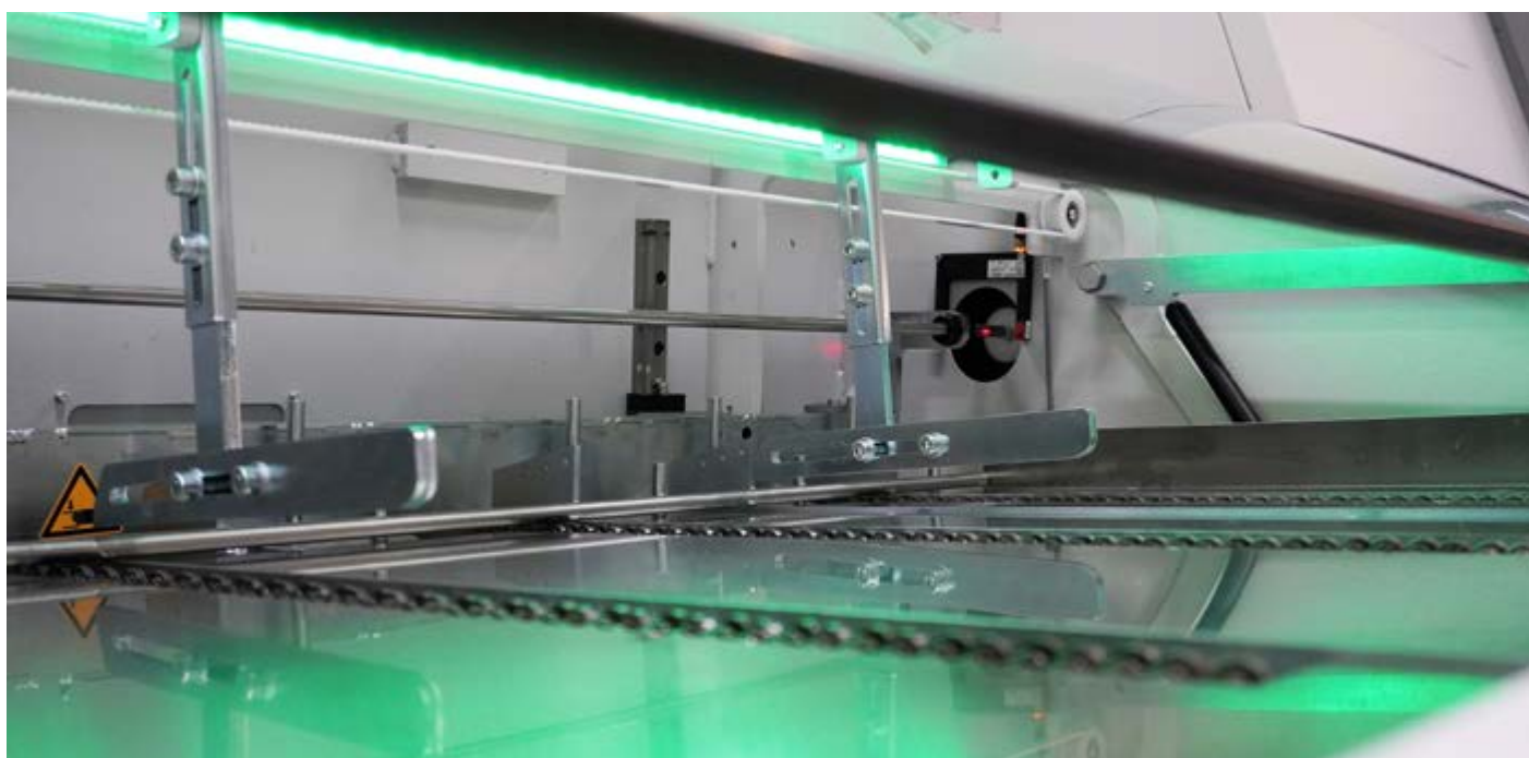
Met behulp van een stangenlader kan G.S.M. onbemand produceren.
