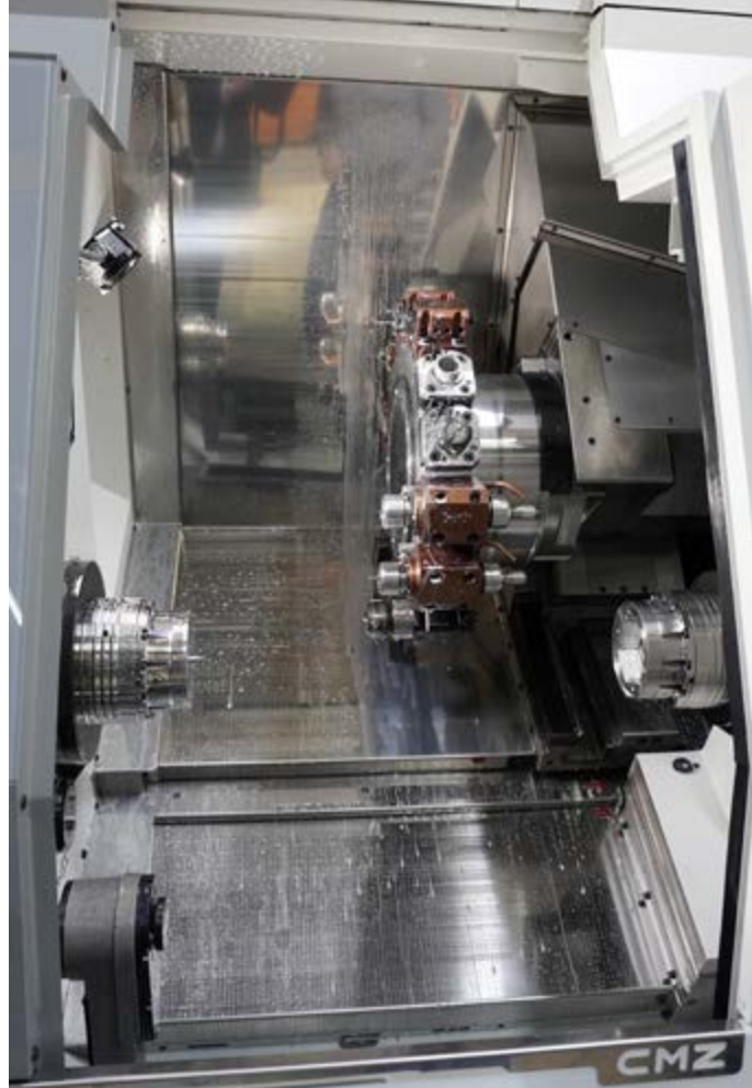
Voor G.S.M. biedt de turret met vijftien aangedreven gereedschappen en de subspil de mogelijkheid om werkstukken compleet te bewerken.
