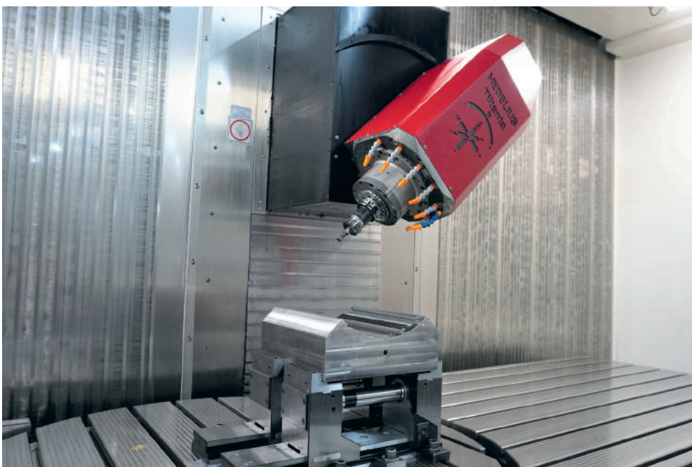
De traploos zwenkbare hoofdspil in combinatie met de geïntegreerde NC-draaitafel maken het vijfassig verspanen van complexe werkstukken mogelijk.
