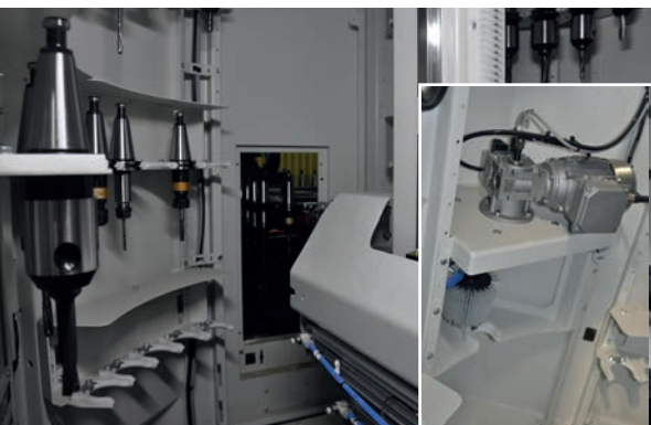
De T7 heeft een standby gereedschapsmagazijn met capaciteit voor 180 gereedschappen en een conus-reinigingsstation (inzet) om de gebruikte gereedschappen te ontdoen van spanen.
