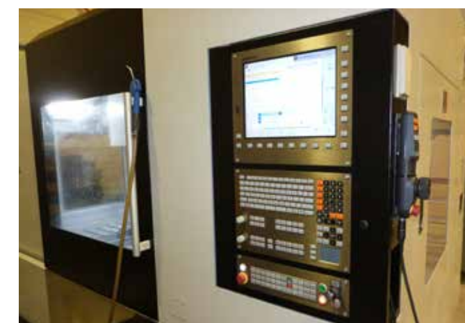
Deze PROMILL is uitgerust met een gereedschapswisselaar met 30 posities en een intuïtieve Heidenhain-sturing zorgt voor een eenvoudige en snelle bediening.
