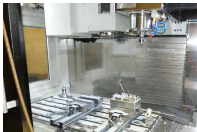
FRT gebruikt dit systeem met een tafel van 1200 x 600 mm voor de bewerking van de meest uiteenlopende werkstukken. De X-, Y- en Z-as hebben een bereik van respectievelijk 1050, 600 en 600 mm.
