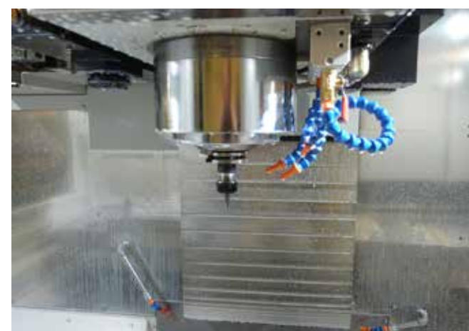
De hoofdspindel met directe aandrijving draait met snelheden tot 12000 toeren/ minuut.
