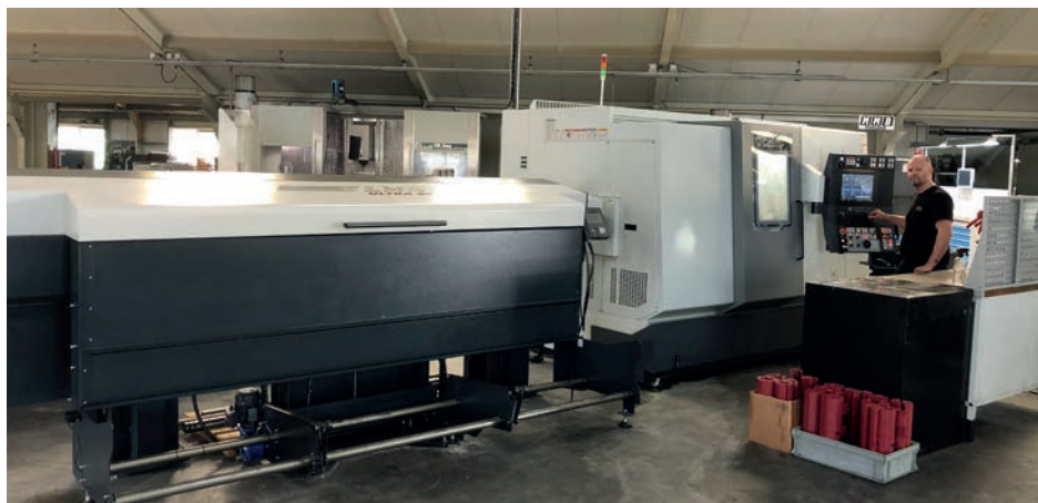
De CMZ TTL 66 52 T1Y T2Y met dubbele turret en speciale LNS-stangenlader.
