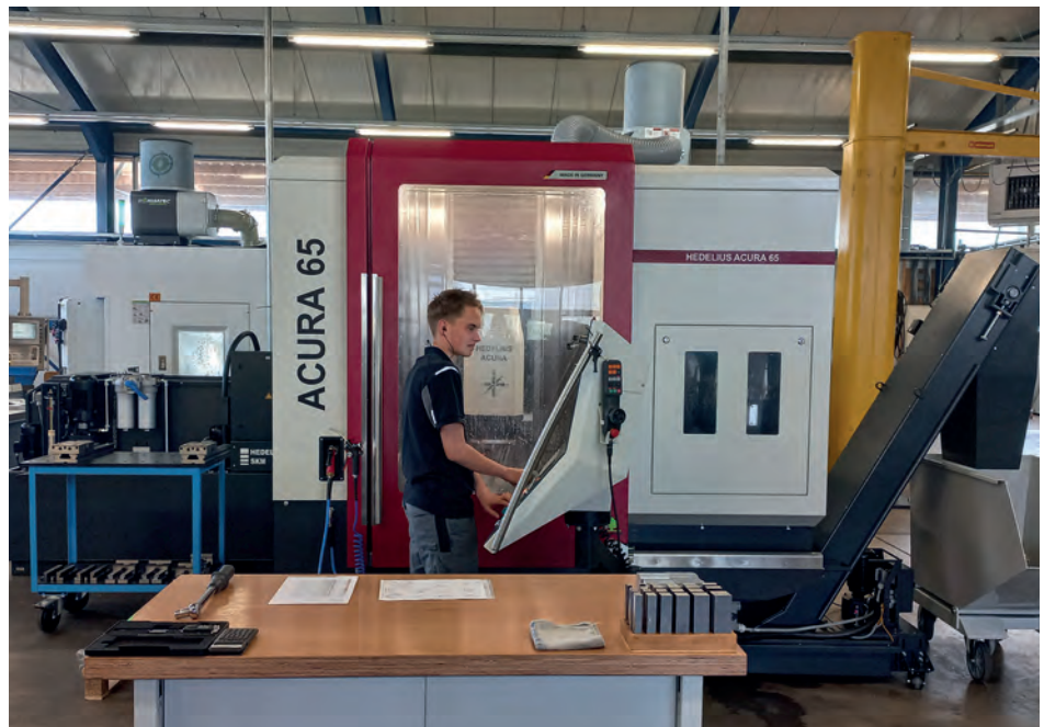
De compacte 5-asser Acura 65 EL is bij uitstek geschikt voor precisiebewerking.
