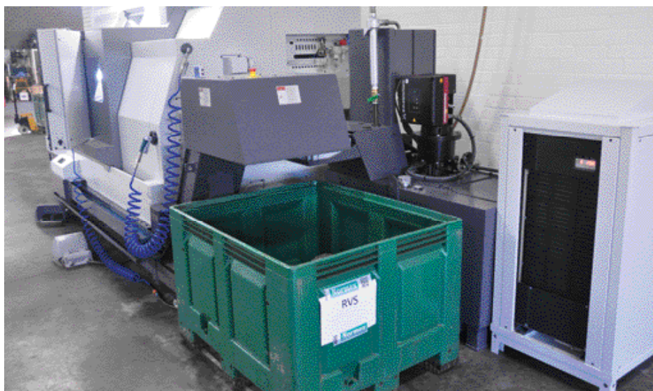
De CMZ is voorzien van hogedruk koelvloeistofinstallatie (met pomp van 70 bar), die een constante temperatuur door de hele machine en motor levert.
