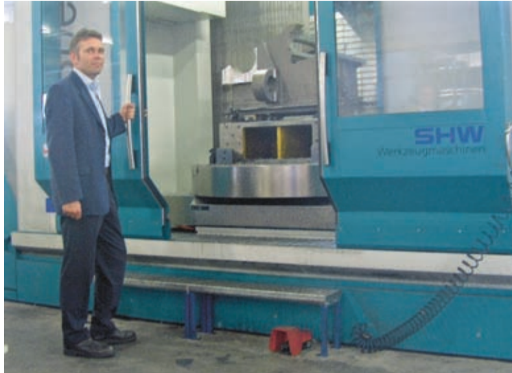
John Hermans: ‘Lekkage is uitgesloten omdat omkasting integraal onderdeel is van de machineconstructie.’
