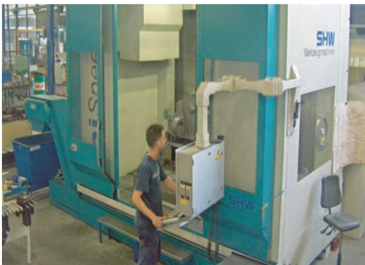
Unispeed 5 biedt een goede toegankelijkheid en goed zicht op het werkstuk tijdens de bewerking.
