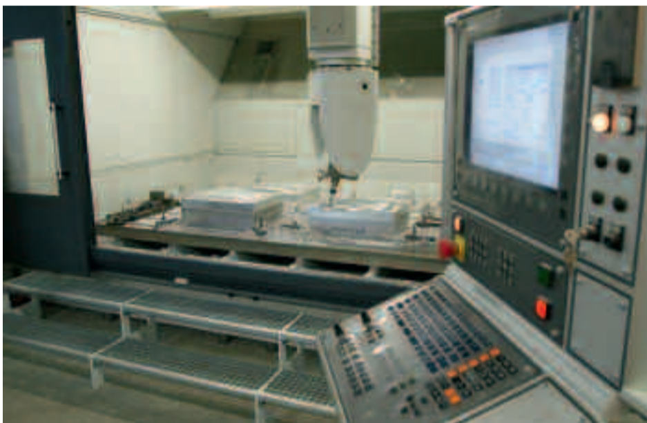
Door slim te combineren en prioriteiten te stellen, benut het bedrijf de voordelen van een portaal-freesmachine. De tafel biedt ruimte voor meerdere werkstukken zodat er altijd capaciteit gevonden kan worden voor spoedorders. (foto: FCP)
